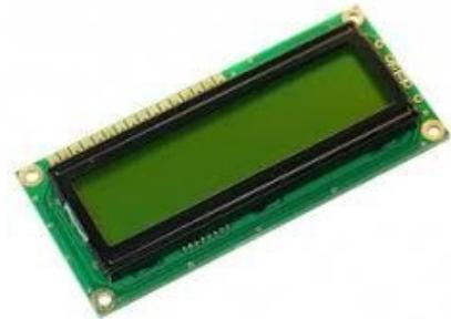
d4, d5, d6 und d7 sind die Nummern der E/A-Pins, die mit den Eingängen D4, D5, D6 und D7 (Eingänge D0 bis D3 und R/W des Moduls sollten mit Masse verbunden werden). „rs“ ist der F, „en“ ist der Pin, der mit dem Freigabe- oder Chipauswahleingang des Moduls verbunden ist.
