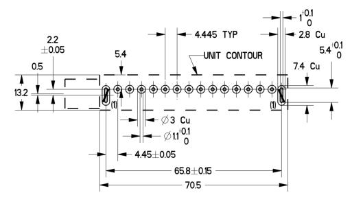
(1) LUG TWIST ANGLE  $30^{\circ}$  IN DIRECTION SHOWN.
